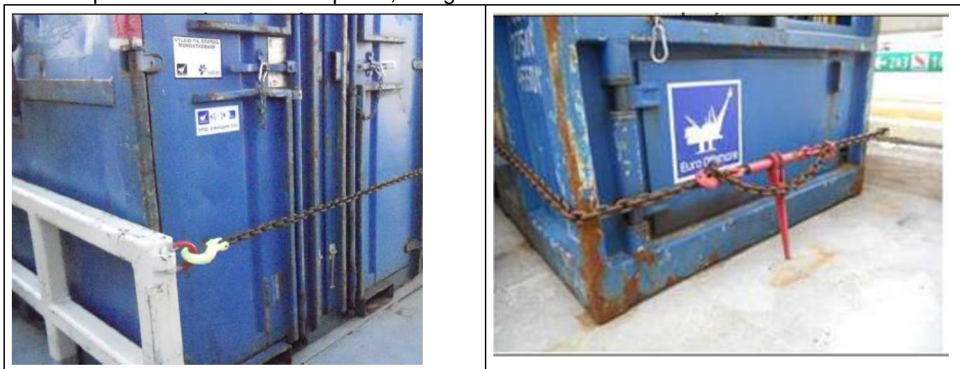
Figur 2: Anbefalt plassering - Last plassert helt inntil bumper
