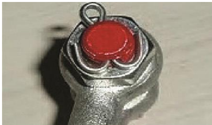
Splittpinne montert i sjakkkelbolt
