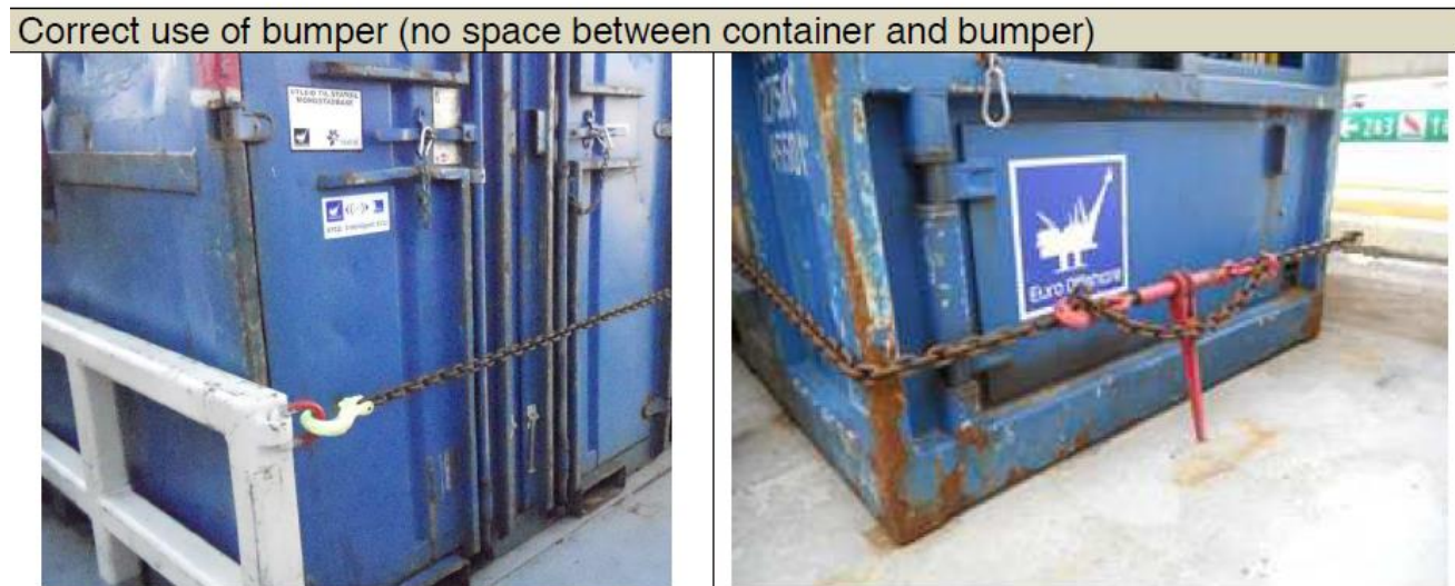
Figur 2: Last plassert helt inntil bumper
